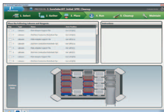
Рис. 3. Выбор протокола, навигация с пошаговыми инструкциями и просмотр правильности расположения требуемого лабораторного пластика и аксессуаров на платформе.
